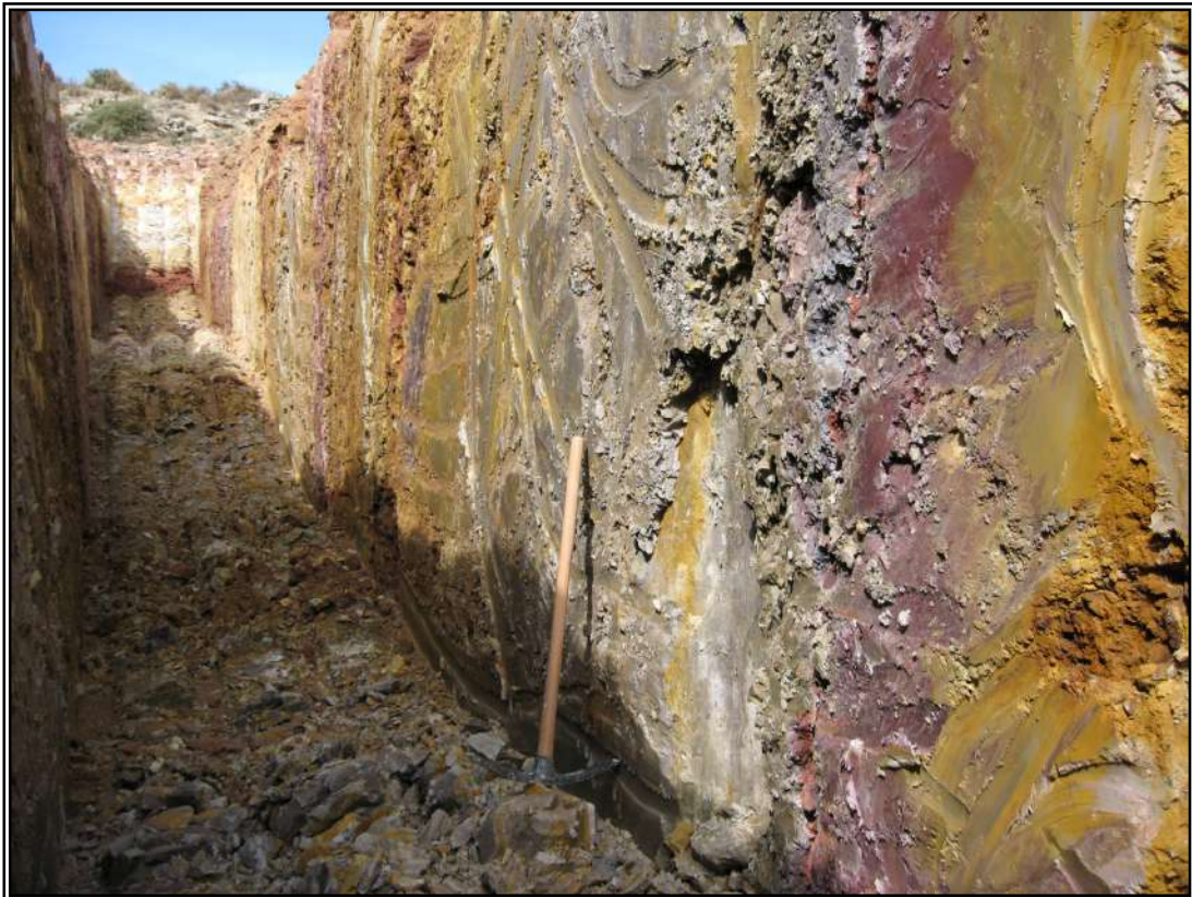
Figura 3.- Arcilla plástica gris en una calicata realizada en la Concesión Valdecastillo.
